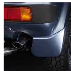
3.10 Брызговики жесткие. Комплект из 2 шт. Могут быть окрашены в цвет кузова. Передние. 99000-99004-X01 (без рис.) Задние. 99000-99056-JBS
