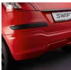
1.8 Спойлер заднего бампера. Загрунтован, рекомендована окраска в цвет кузова или в два цвета. 1,3,4
