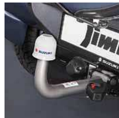
4.11 Съёмный фаркоп. Макс. допустимая нагрузка на крюк фаркопа: верт. — 75 кг. Электрический разъем для подключения фонарей прицепа заказывается отдельно. Доп. информация указана в руководстве по эксплуатации Вашего автомобиля. Не совместим с задним порогом 99000-990YB-713. 99000-990YV-012
