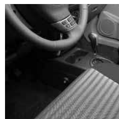
3.17 Замок АКПП. Противоугонное устройство бесштыревой конструкции. Отличается простотой в эксплуатации и удобством использования. Блокировка рычага КПП производится в положении Parking. 990NB-40003-000
