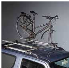
4.7 Крепление для велосипеда «Giro Speed». Для перевозки велосипеда с демонтированным передним колесом (только в сочетании с багажником 990E0-79J14-000). 990E0-59J21-000
