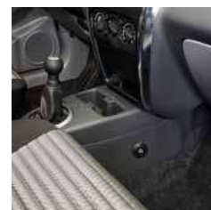
3.18 Замок МКПП. Противоугонное устройство бесштыревой конструкции. Отличается простотой в эксплуатации и удобством использования. Блокировка рычага КПП производится в положении заднего хода. 990NB-40002-000
