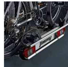
4.14 Дополнительный модуль для крепления велосипедов. Используется для перевозки 3-го велосипеда (только в сочетании с креплением 990E00-59J22-000). 990E0-59J22-001
