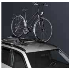
4.9 Крепление для велосипеда «Barracuda». Для перевозки велосипеда полностью, с универсальным удобным замком, рычаг крепления может монтироваться справа или слева (только в сочетании с багажником 990E0-79J14-000). 99000-990YT-206
