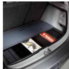
2.16 Органайзер багажника. Отлично подходит для размещения вещей в багажнике и оставляет много свободного пространства при опущенных задних сиденьях. Крышка органайзера покрыта ковровым материалом, а его внутренняя поверхность выполнена из прочного, устойчивого к ударам и воздействию химических веществ пластика. 990E0-79J40-000
