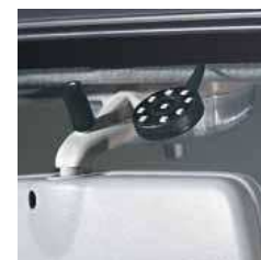
3.12 Датчик дождя. Автоматически включает дворники лобового стекла, подбирает оптимальный режим и интервал их работы. 990E0-65J81-000
