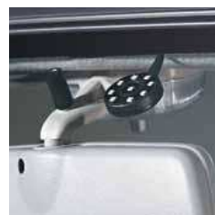
3.21 Датчик дождя. Автоматически включает дворники лобового стекла, подбирает оптимальный режим и интервал их работы. 990E0-65J81-010
