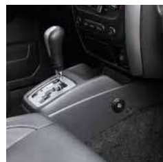
3.13 Замок АКПП. Противоугонное устройство бесштыревой конструкции. Отличается простотой в эксплуатации и удобством использования. Блокировка рычага КПП производится в положении Parking. 990NB-40001-000
