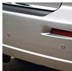
3.7 Датчики парковки. Комплект из 4 шт. с пьезоэлементами. Сенсоры могут быть окрашены в цвет кузова. 990E0-68L53-015
