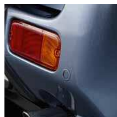
3.9 Датчики парковки. Комплект из 4 шт. с пьезоэлементами. Сенсоры могут быть окрашены в цвет кузова. 990E0-68L53-015
